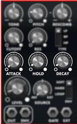
Abbildung 24 Die NOISE-Attack, Hold und Decay-Parameter
