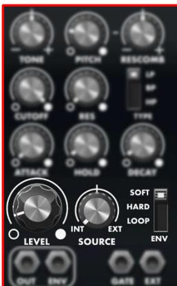
Abbildung 25 Die NOISE-Level, Source und ENV-Parameter
