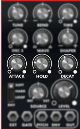
Abbildung 13 Die OSC-Attack/Hold/Decay-Parameter
