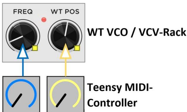
Abbildung 21 Die Drehregler beeinflussen das WT-VCO-Modul
