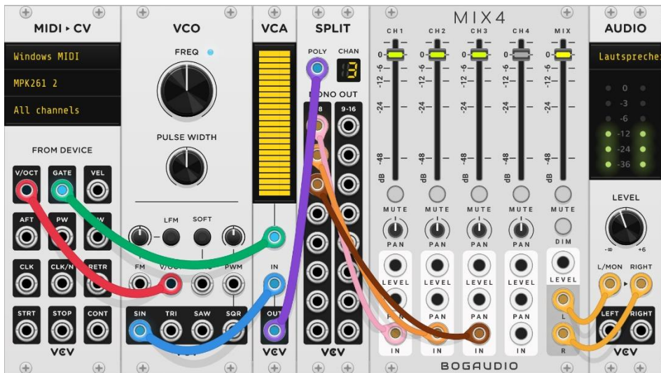
Abbildung 46 Ein einfacher Patch mit dem MIX4-Modul von Bogaudio und einem SPLIT-Modul
