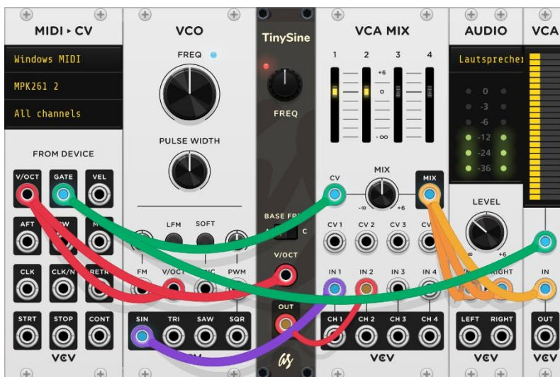
Abbildung 41 Das Monophonic-Signal des TinySine-Moduls wird dem Polyphonic-VCA-MIX-Modul zugeführt
