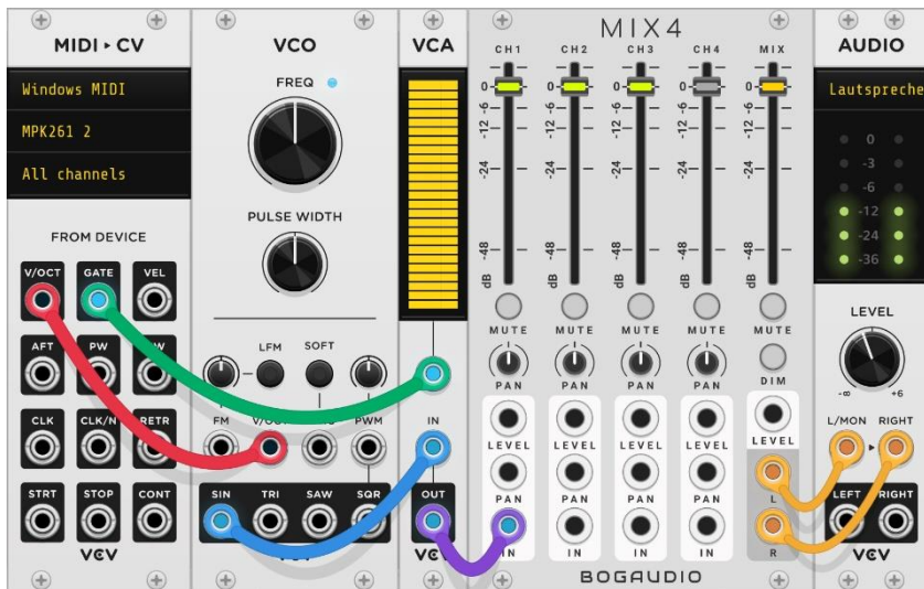
Abbildung 50 Ein einfacher Patch mit dem MIX4-Modul von Bogaudio - Mit Spread-Funktion
