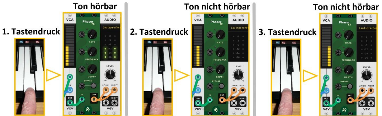
Abbildung 35 Nur der 1. Kanal wird erkannt
