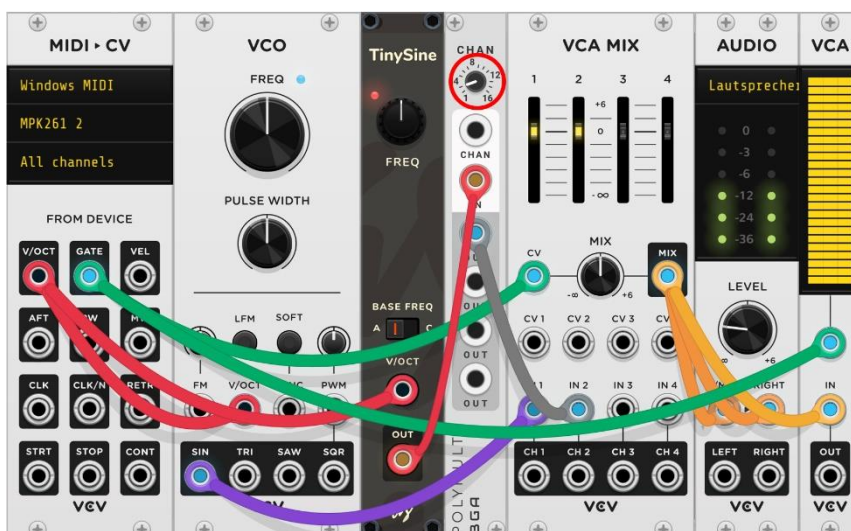
Abbildung 43 Das POLYMULT-Modul im Signalfuss
