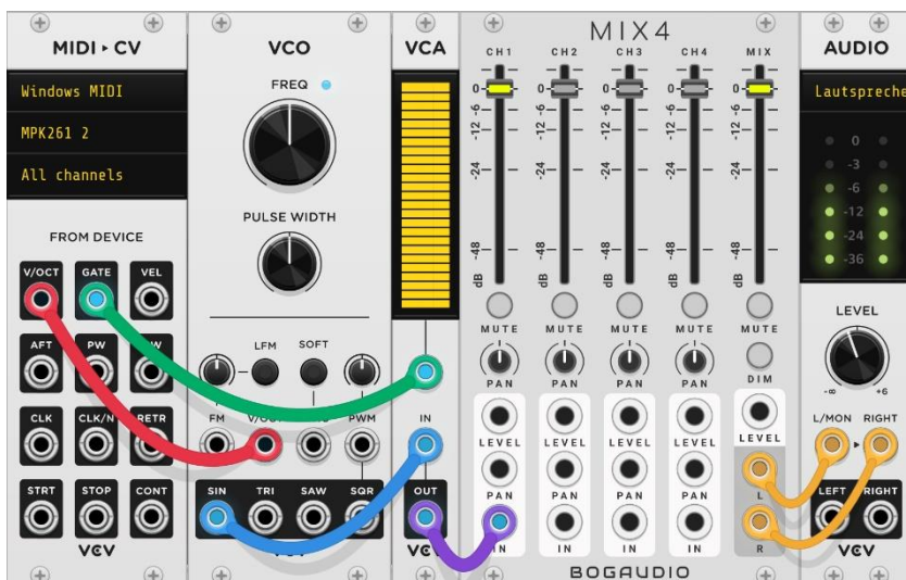
Abbildung 45 Ein einfacher Patch mit dem MIX4-Modul von Bogaudio
