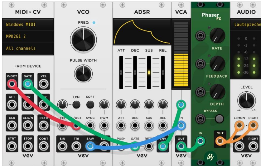
Abbildung 34 Ein nicht Polyphonic-Modul (Phaser-FX) im Signalfluss
