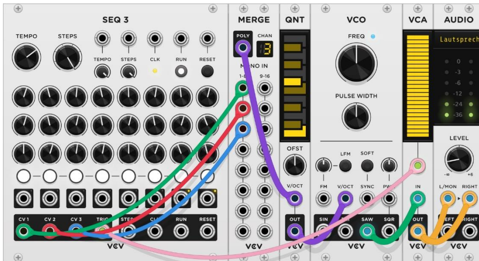
Abbildung 40 Das Monophonic TRIG-Signal des SEQ-3-Moduls steuert das Polyphonic-VCA-Modul an
