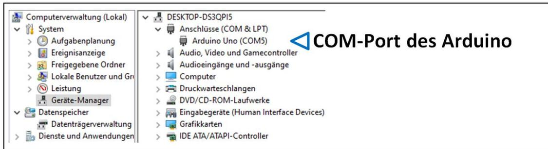
Abbildung 9 Der COM-Port des Arduino-Boards
